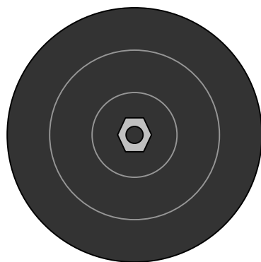
Gleichstromlichtmaschine (Zylindrische Form, Gehäuse ist bei Draufsicht von Riemenscheibe verdeckt, 6 und 12 V, max. 45 A )
